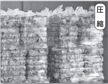
圧縮 選別されたものは約40kgのかたまりに圧縮されます。
