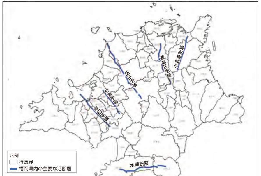
図. 想定地震の震源断層分布図
