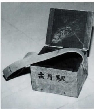
合図灯用電池箱 列車の出発や到着の合図に使われていた合図灯の電池を入れていた箱。電池は、毎日、信号区の充電室に送受されていた。この電池箱は、室木線の古月駅で使われていたもの。
