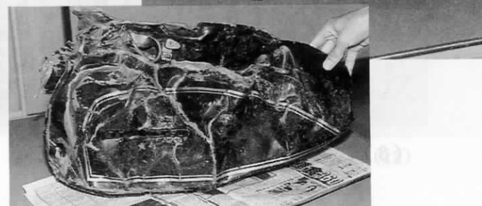
今回の爆発の原因とみられるバイクの燃料タンクと、焼却炉を痛める原因となる金属類。
